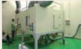
اختبار التسعير الحراري Calorimeter testing
